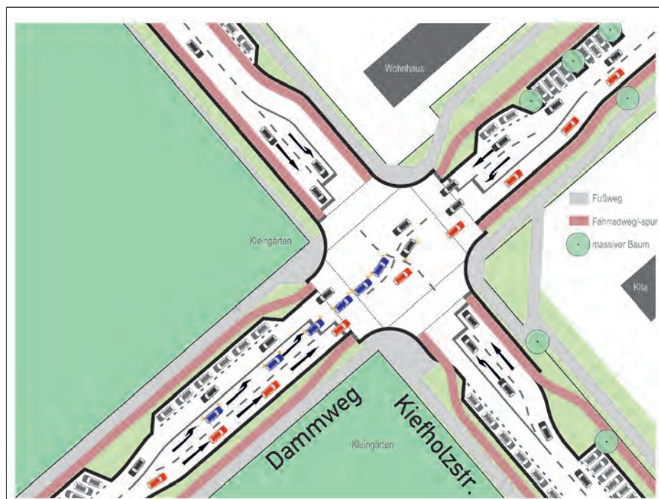
Wettbewerbsvorschlag, weiter entwickelt: Da das Problem in abgeschwächter Form auch an den anderen Zufahrten der Kreuzung besteht, sollten gleich vier Linksabbiegerspuren eingerichtet werden. (Entwurf und Grafik: Axel Rühle; weiterentwickelte Idee eines fremden Wettbewerbsbeitrags)
